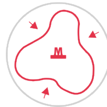
Det faktiske stationsopland minimeres, hvis der er barrierer og omveje for fodgængere
